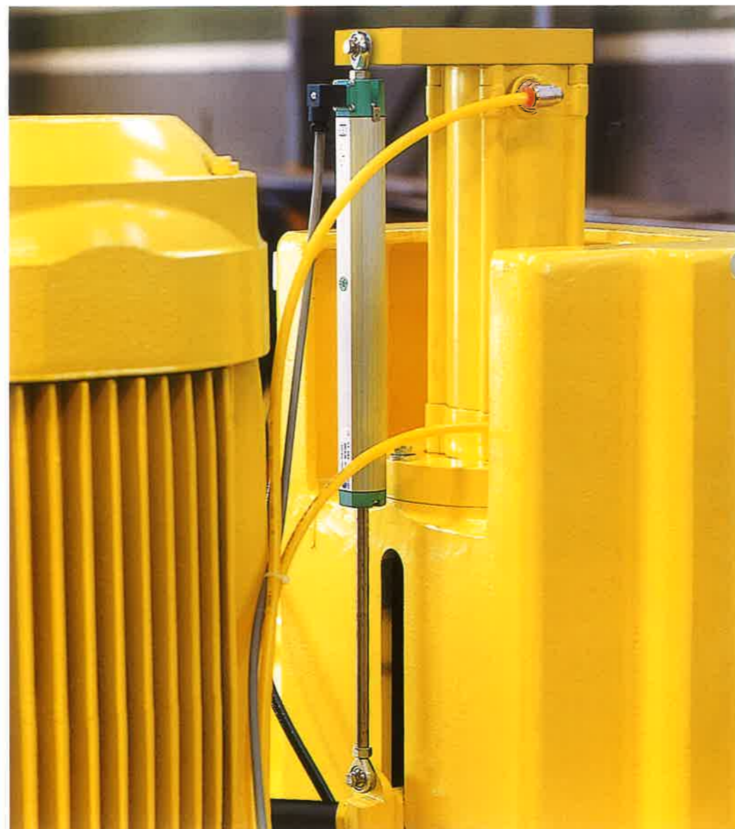
A lato: dispositivo ad encoder lineare per il controllo consumo abrasivi completamente automatico
