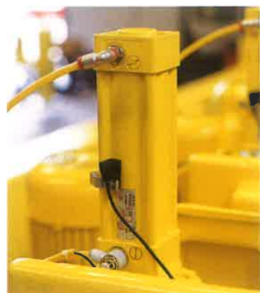
Dispositivo CCA optional per il controllo consumo abrasivi, a regolazione manuale (su ogni mandrino levigante)
