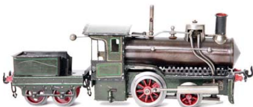
71 Falk, 116R Storchenbein Spiritusbetrieb, oszillierender Zylinder mit Dampfpeife und Sicherheitsventil, V+R, L29cm, Z1-2
