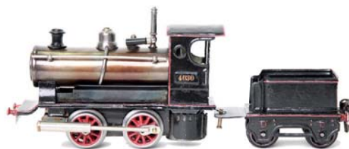
8125 Märklin S 0, 4030 Dampflok mit Tender, v.1906, Spiritusbetrieb, oszillierende Zylinder, L26cm, Z1-2
