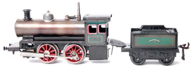
27 Bing S 0 , 160/1569 Dampflok mit Tender Spiritusbetrieb, von 1912, oszillierender Zylinder, L30cm, Z1
