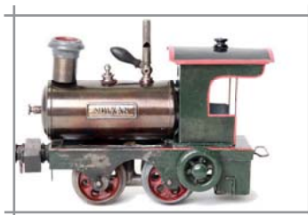
8247 Plank, S0 402 Dampf-Spirituslok ‚Vulkan‘ ,von 1903, Tender fehlt, mit Brenner , Sicherheitsventil und Dampfpeife, oszillierender Zylinder mit außenliegendem kleinen Schwungrad, L16,5cm Z1-2
