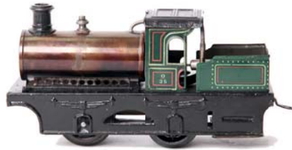
8259 Bing S 0, Tenderlok ,Spiritusbetrieb, von 1906, mit Schwungscheibe im Führerhaus , 1 oszyl. Zylinder, grün schwarz, L17cm, Z1
