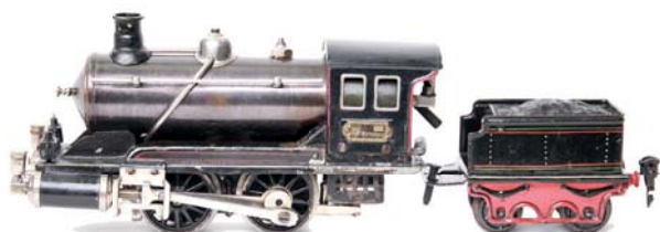
8126 Märklin S 0, Dampflok mit Tender Spiritusbetrieb, doppelt wirkende Zylinder, Dampfpeife, L34cm, Z1-2
