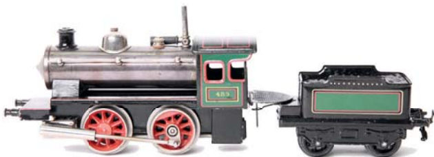
28 Bing S 0 , 160/1573 Dampflok mit Tender 485 von 1912, Spiritusbetrieb, oszyll. Zylinder, L33cm, Z1
