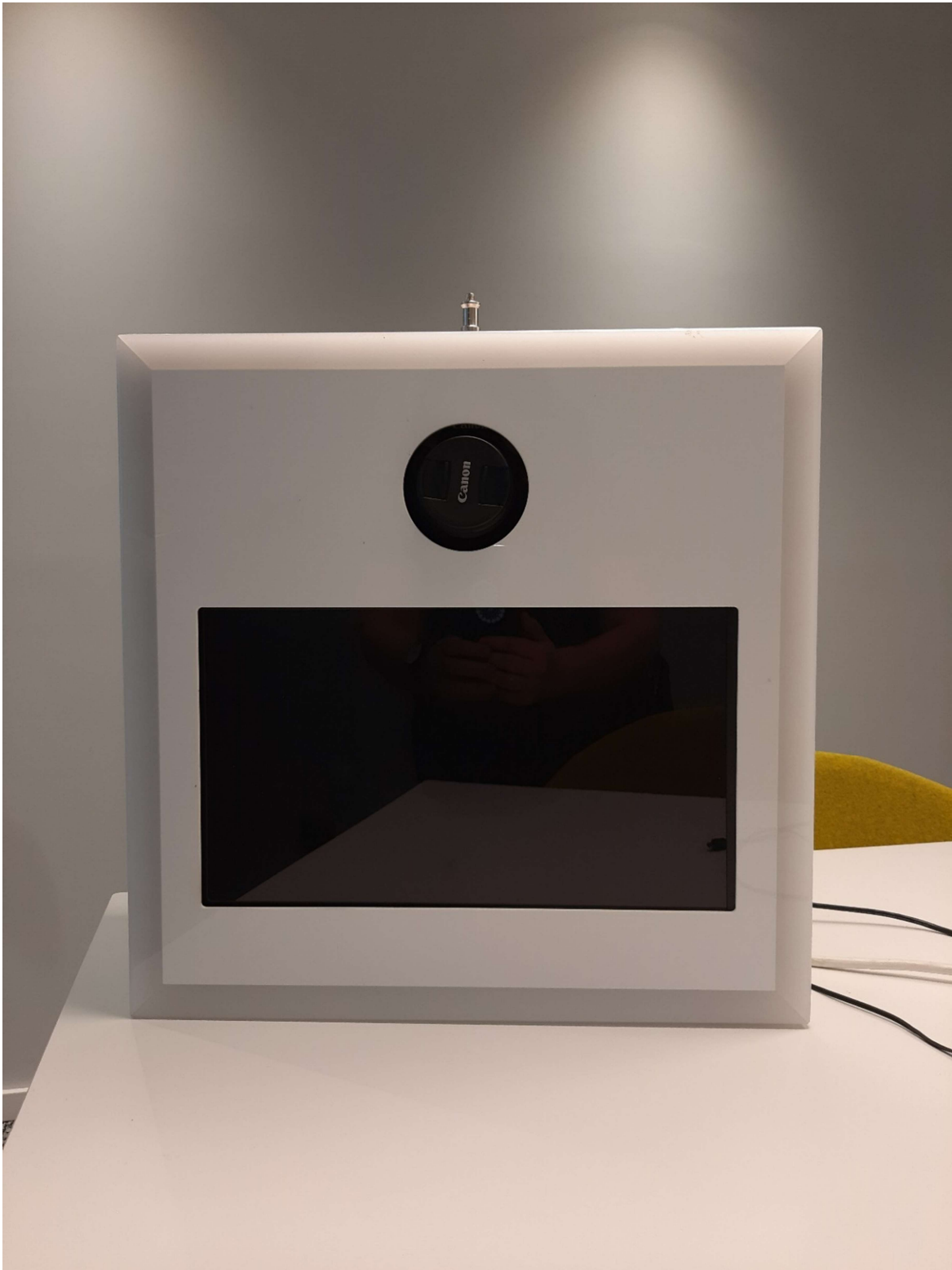
Beispiel Box Vorderseite mit Monitor und Kameraausschnitt, oben Befestigungsmöglichkeit Blitz/Beleuchtung
