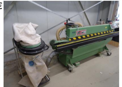
**76 Kantenanleimmaschine HEBROCK AKV 068**
