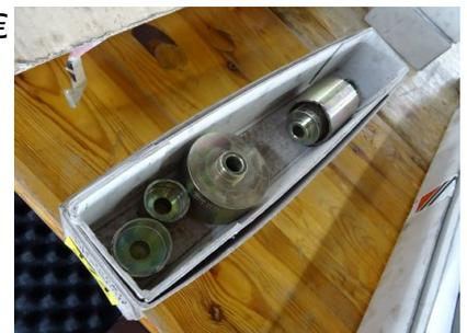
**175 1 Werkzeug Hinterachslager VW/AUDI
