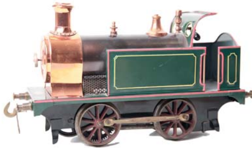
752 Bing S3 13761/3 Tenderlok mit Echtdampf betrieben. ‚Kraftlokomotive‘, Saisonneuheit von 1904. Mit oszillierendem Zylinder in Rauchkammer mit Zugknopf vor und zurück an Rauchkammertür. Spiritusbrenner, Dampfpeife. L32cm, Die Maschine wurde 1975 farblich restauriert. L32
