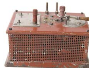
8143 Märklin S 1, 3073N Universal Zwischenschalt-Apparat für Schwebenanlage. Vorschaltwiderstand für Gleich und Wechselstrom für Spannungen 110-250V Der Apparat reguliert die Spannung und bewirkt bei Kurzschluss die automatische Ausschaltung des Stromes. Verbesserte Version der Type 3073 1906 Kat. H II. Nachtrag S.115
