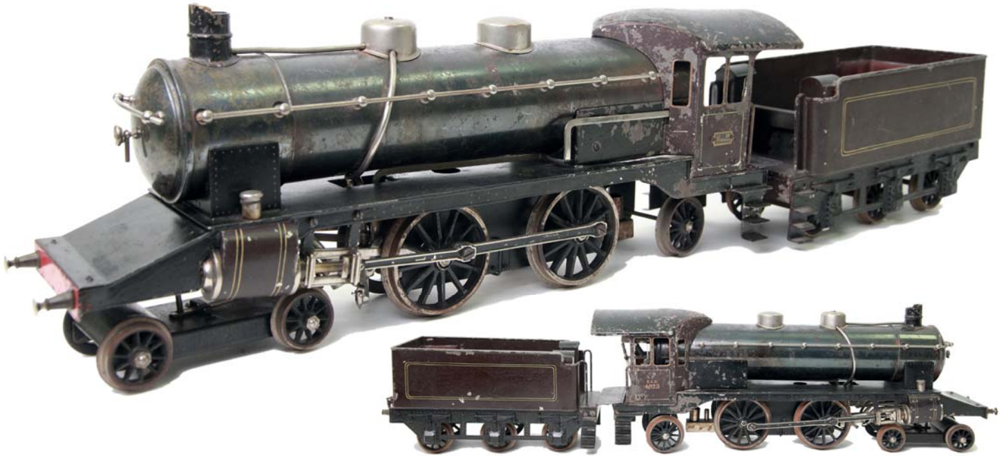
8145 Märklin, S3, Dampflokomotive mit Tender, 2B1, spiritusbetrieben, langsam und schnell fahrend, mit Manometer, Lampen fehlen, L90cm, Z2
